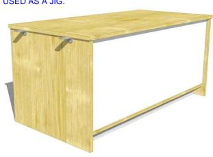
OFFER UP THE INFILL PANEL TO YOU DDA UNIT, ENSUING THAT THERE IS AN EVEN BREAK (2MM) FRONT AND BACK. FIX THE PANEL TO THE DDA UNIT
